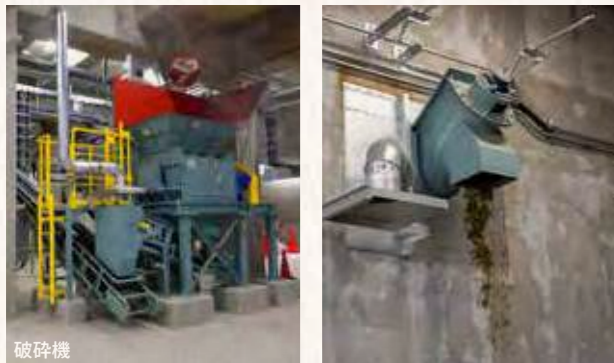
最初に、ゆっくりと回転する破碎機で粗く砕き、チップ化します。
