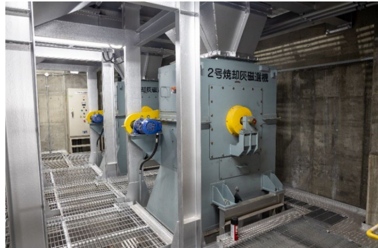
焼却灰磁選機は、燃えるごみに混ぜってしまった鉄分を磁石の力で取り出す機械です。
